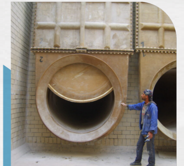
Vanne à guillotine DN1800 en SVR
